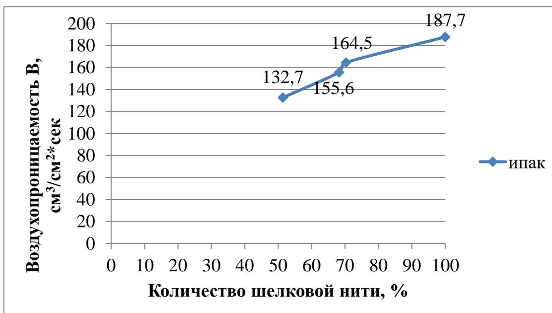
**Рис.1. График зависимости количества шелковых нитей от показателей воздухопроницаемости двухслойного хлопчатобумажного трикотажного полотна**
