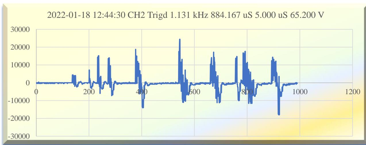
Фигура 2. Вибрации вала использованного сепаратора показывают, что мгновенные импульсы скорости различаются на 100-200 микросекунд, а также имеются частичные различия в их амплитудных значениях. Невозможно обеспечить постоянную однородность движения хлопка в сепараторе. Поэтому различия на графике будут незаметны.
