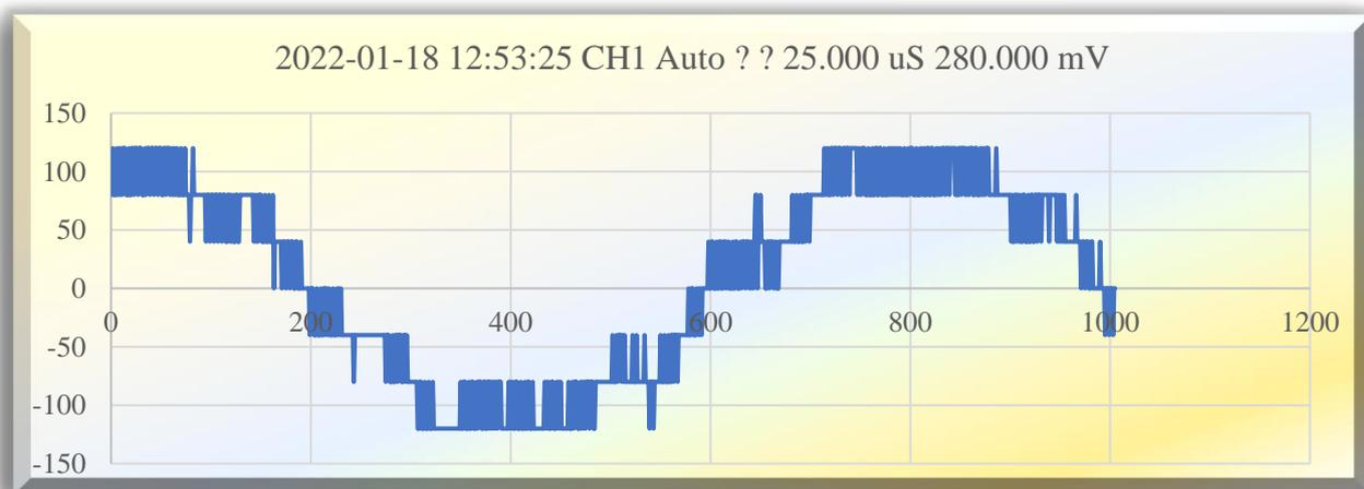
Рисунок 3. Вибрация вала сепаратора после нового диффузора и установки
