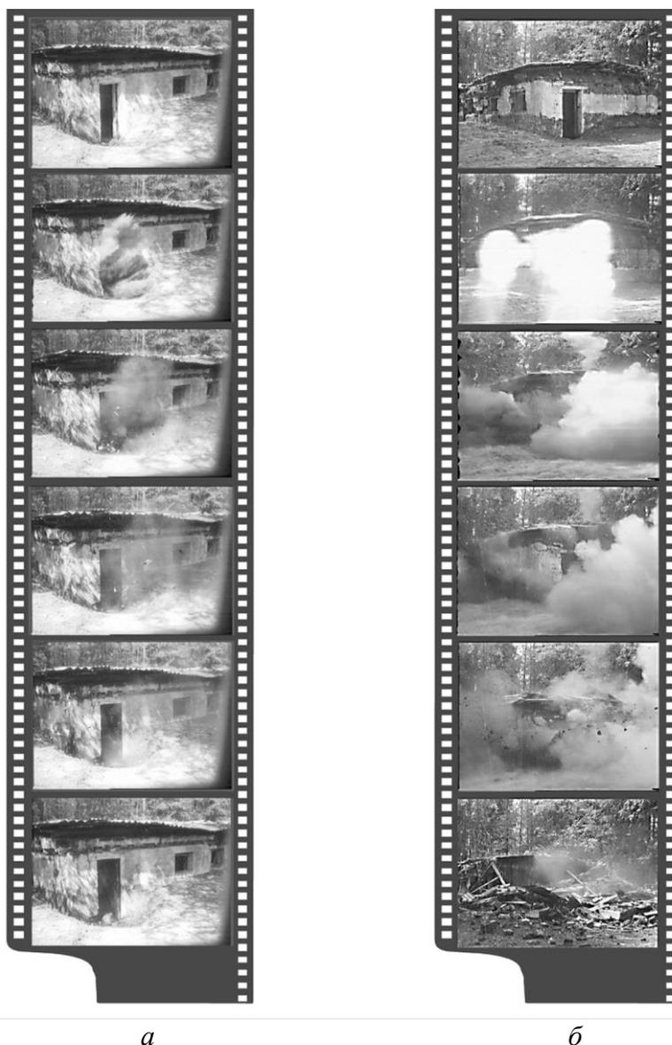
Рис. 1. Кинограммы процессов внутреннего взрыва в зданиях:
