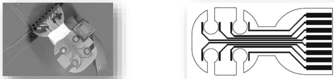
Рис. 2 .Конструкция несущей платы для микрочипов (4 канала)
