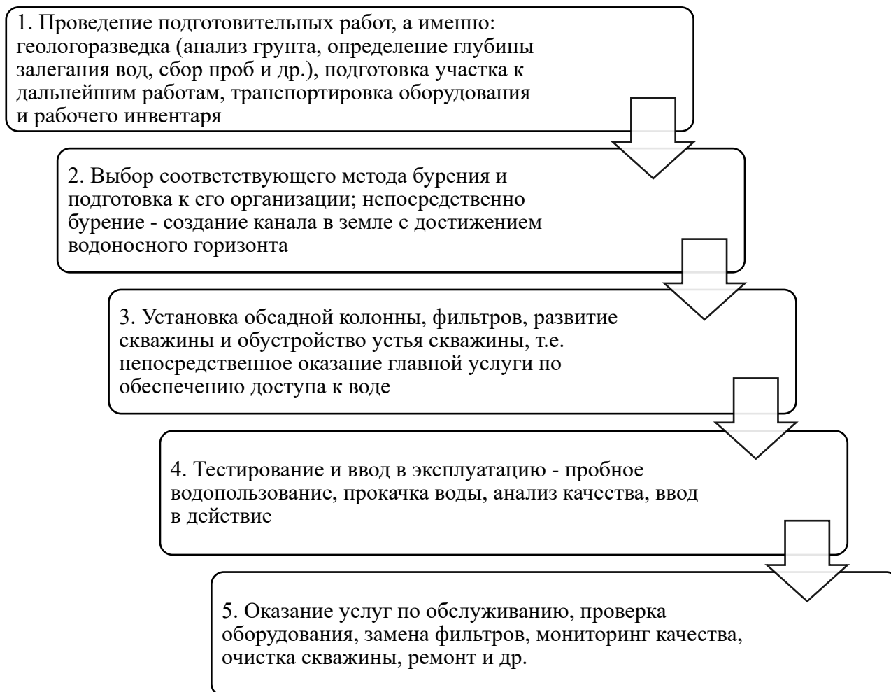
Рисунок 2 – Структура этапов процесса бурения водозаборных скважин, составлено автором.
