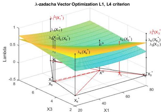
Рис. 16. Решение  $\lambda$ -задачи ( $\lambda_1(X)$  и  $\lambda_4(X)$ ) в трехмерной системе координат  $x_1$   $x_3$  и  $\lambda$ .  $\lambda_2(X^0) = \lambda_3(X^0) = 0.5196$  (точно на пересечении).
