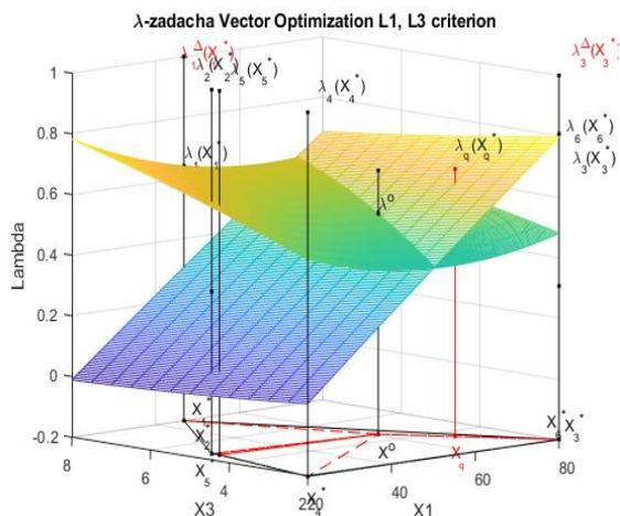
Рис. 15. Решение  $\lambda$ -задачи ( $\lambda_1(X)$  и  $\lambda_3(X)$ ) в трехмерной системе координат  $x_1$   $x_3$  и  $\lambda$ .  $\lambda_1(X^0) = 0.7372, \lambda_3(X^0) = 0.5196$ .
