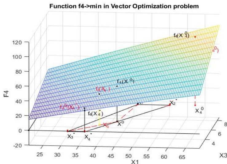
Рис. 12. Геометрическая интерпретация четвертой характеристики материала  $f_4(X)$  в натуральных показателях
