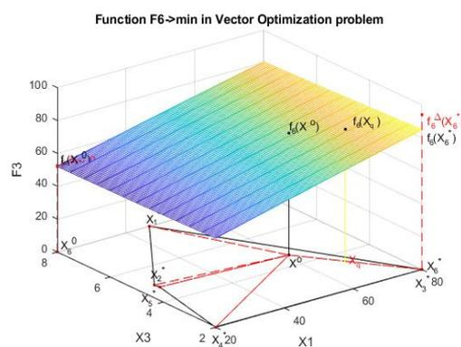
Рис. 22. Шестая характеристика технической системы  $f_6(X)$  в натуральных показателях
