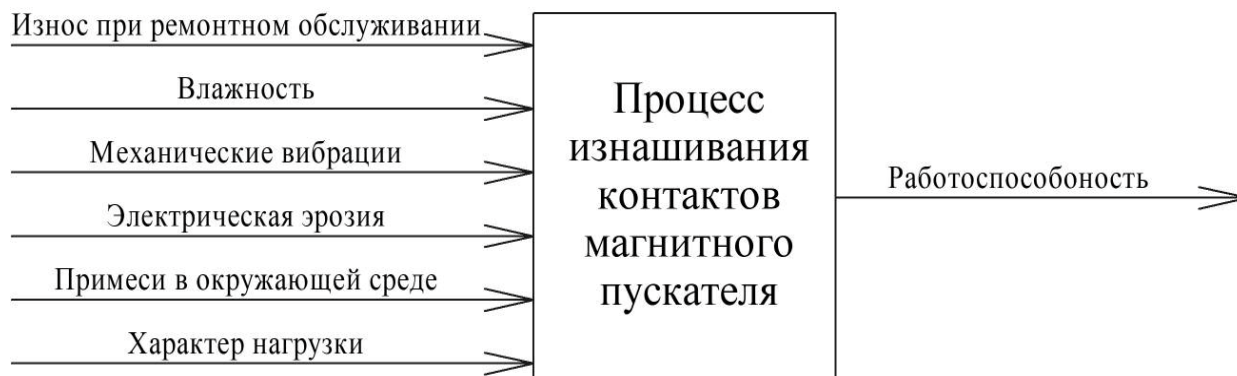
Рисунок 3 – Факторы влияющие на работоспособность контактов магнитного пускателя
