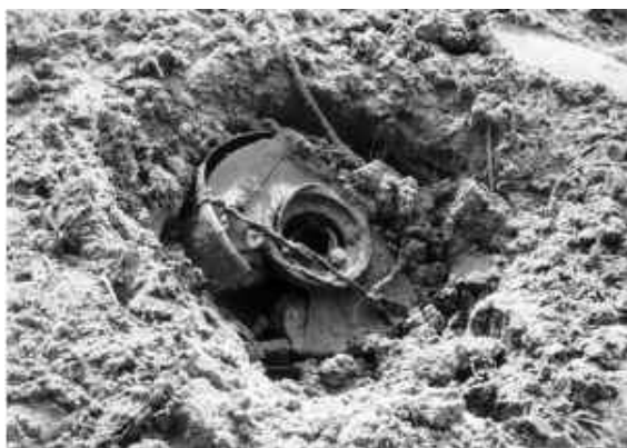
Рис. 2. Противотанковая мина, уничтоженная мощным гидроразрушителем через слой грунта толщиной 15 см
