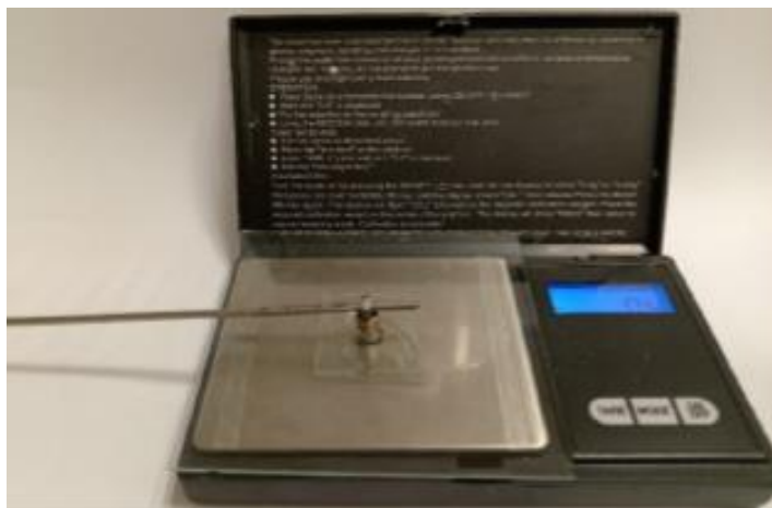
Рисунок 1. Модель лабораторного эксперимента для исследования адгезивных свойств местных гемостатических средств
