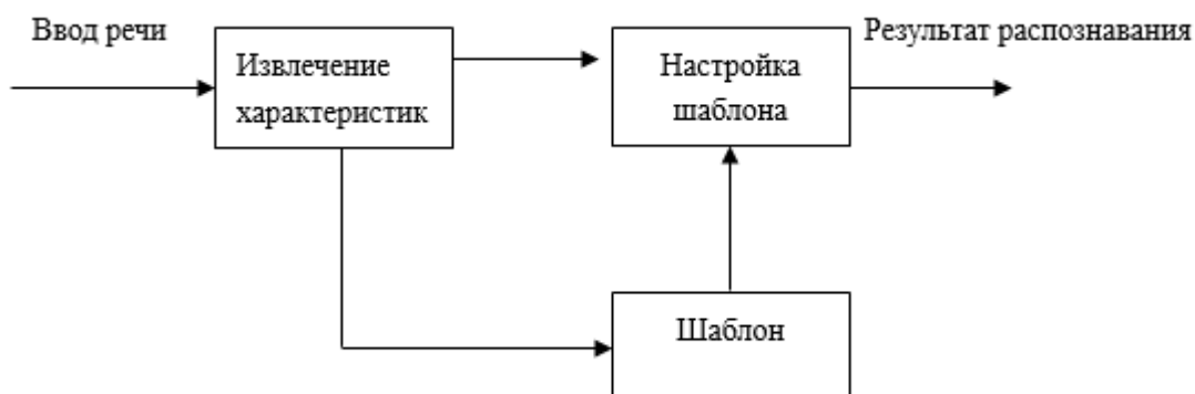
Рисунок 2– Процесс реализации системы распознавания речи
