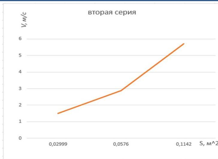
Рисунок 7. Зависимости скорости водного потока от площади поперечного сечения на входе конфузора 2-го вида.
