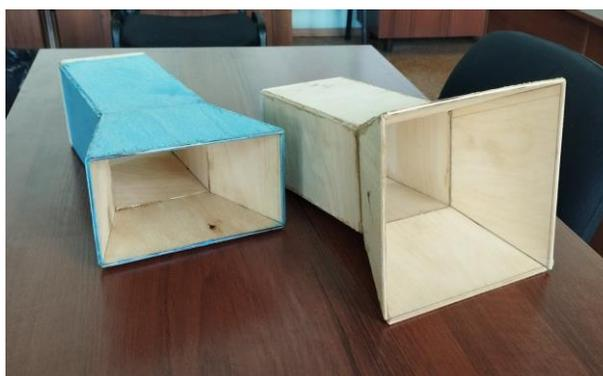
Рисунок 2. Слева – конфузор плоского сужения, справа – всестороннего сужения.
