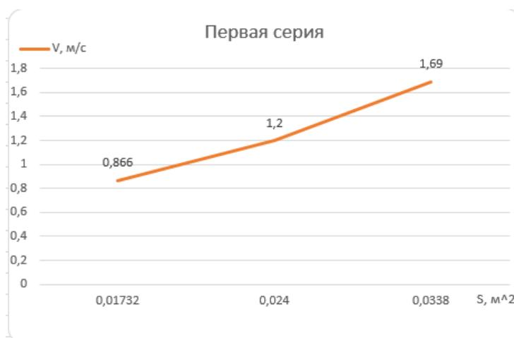
Рисунок 6. Зависимости скорости водного потока от площади поперечного сечения на входе конфузора 1-го вида.
