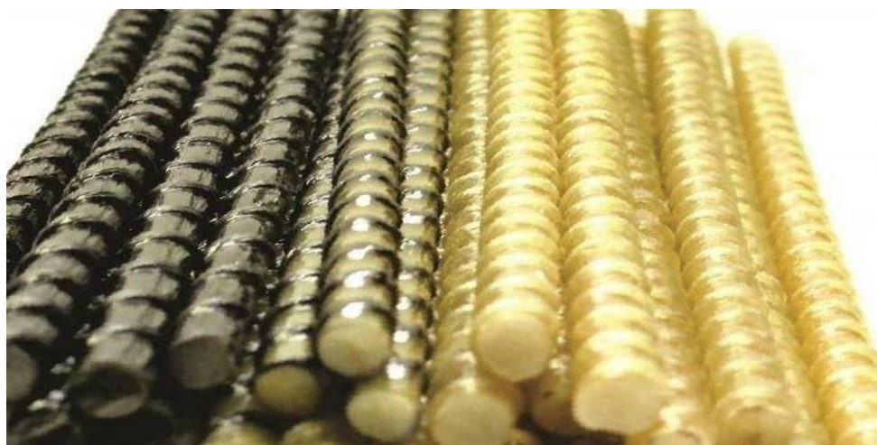
Рисунок 1 – Композитная арматура на основе стеклянных и углеродных волокон
