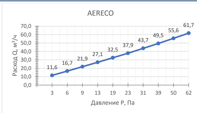
Рисунок 3. Зависимость расхода воздуха от перепада давления оконного приточного клапана AERECO
