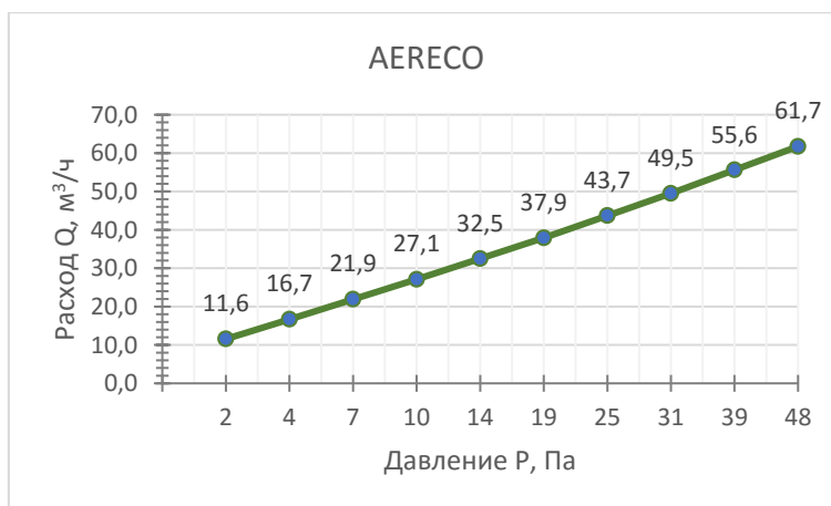
Рисунок 4. Зависимость расхода воздуха от перепада давления оконного приточного клапана AERECO (Без оконного профиля)
