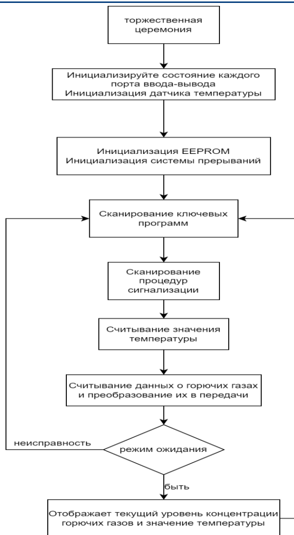
Рис. 1 – Схема, показывающая текущий уровень концентрации горючего газа и значения температуры
