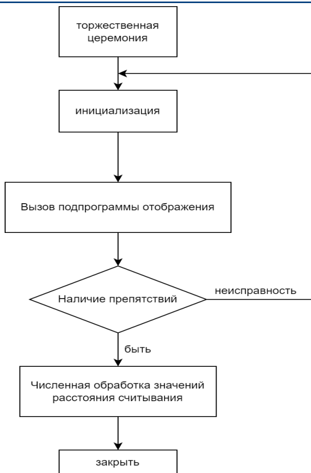
Рис. 2 – Цифровая схема измерения расстояния с использованием ультразвуковых датчиков
