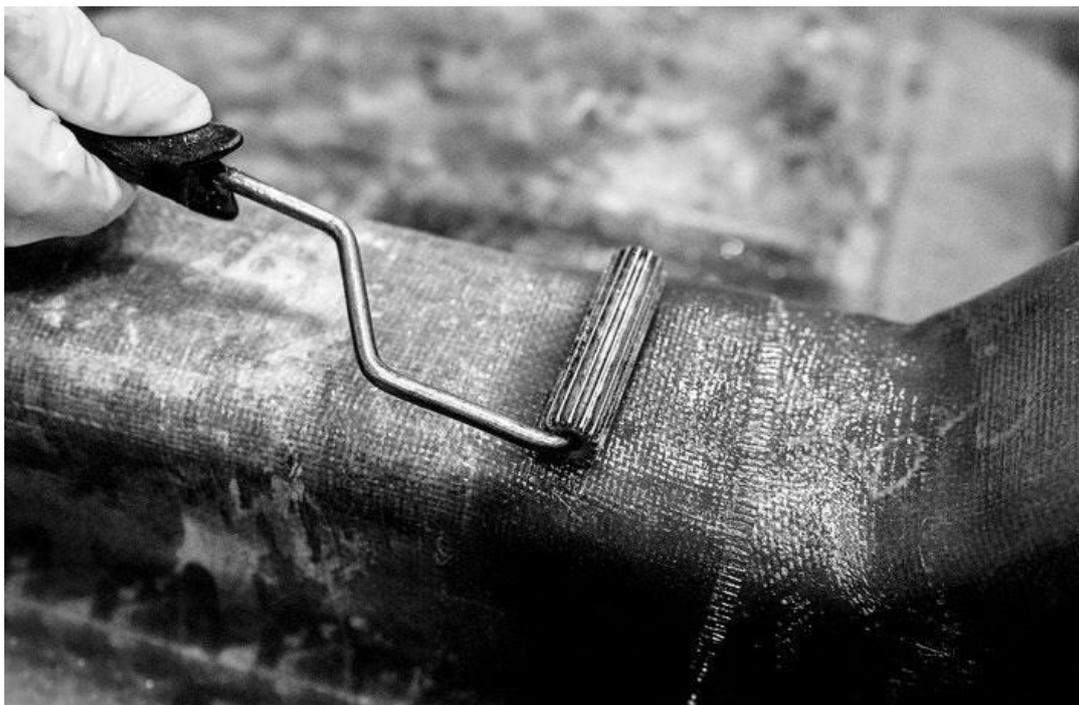
Рис.1 При контактном формовании каждый слой прокатывается валиками
