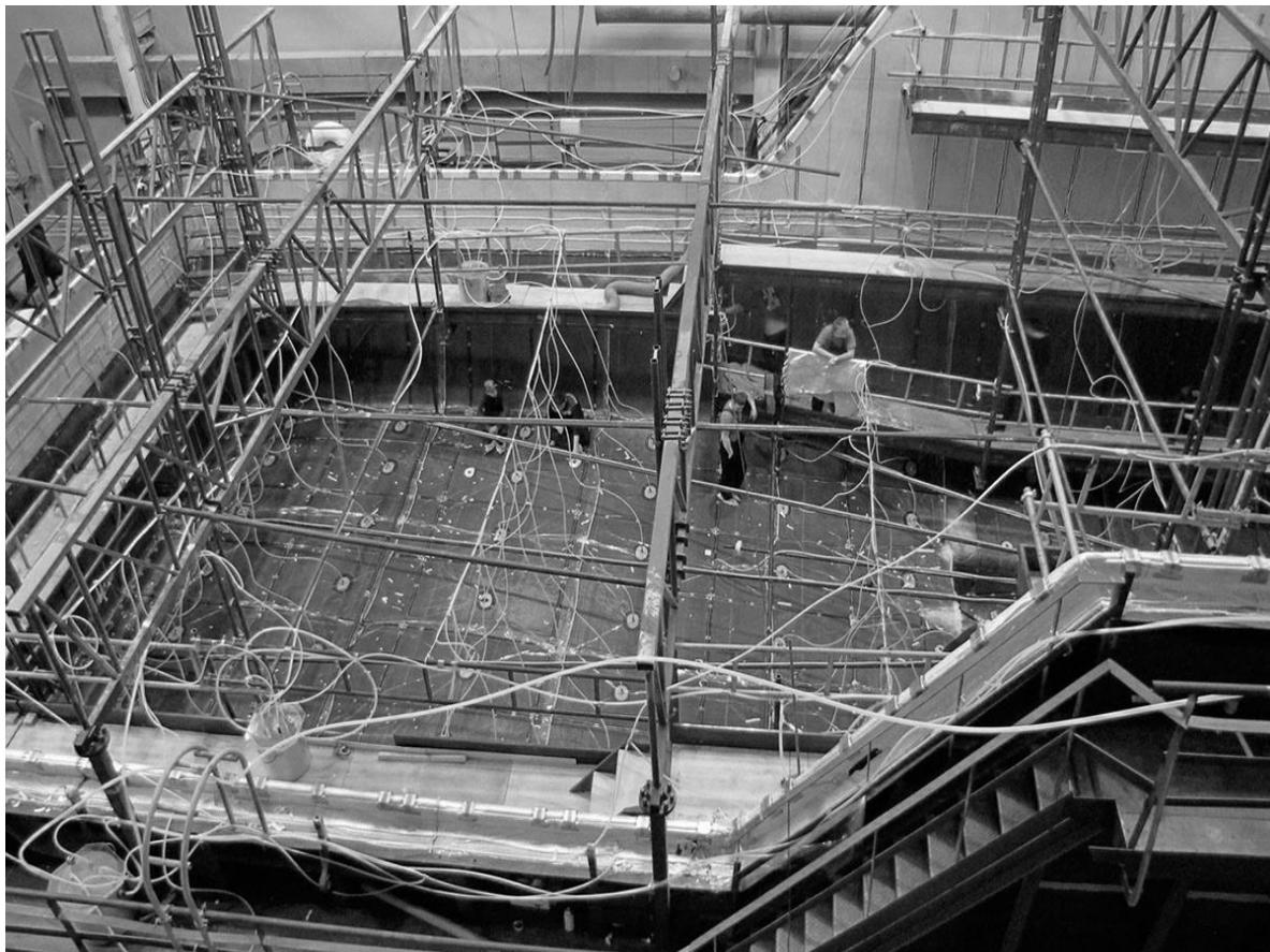
Рис.2 Формовка корпуса методом вакуумной инфузии
