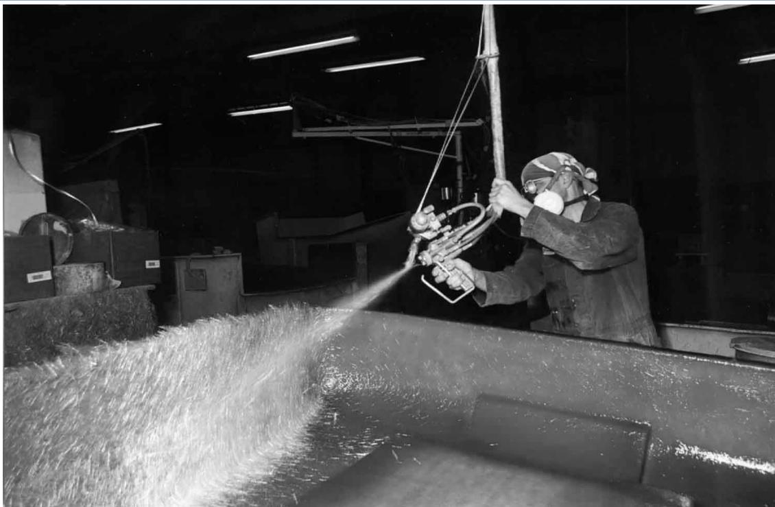
Рис. 3 Метод напыления рубленых нитей стекловолокна в формообразующую оснастку при помощи специального оборудования
