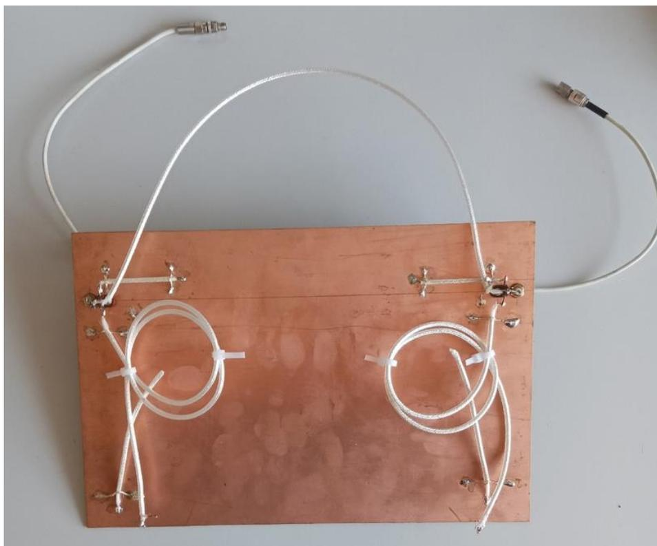
Рис. 2. Фото фильтра из отрезков коаксиального кабеля
