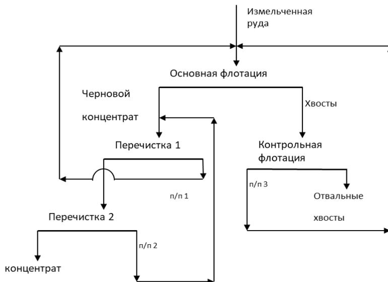
Рис. 11.4 Схема флотационного процесса
