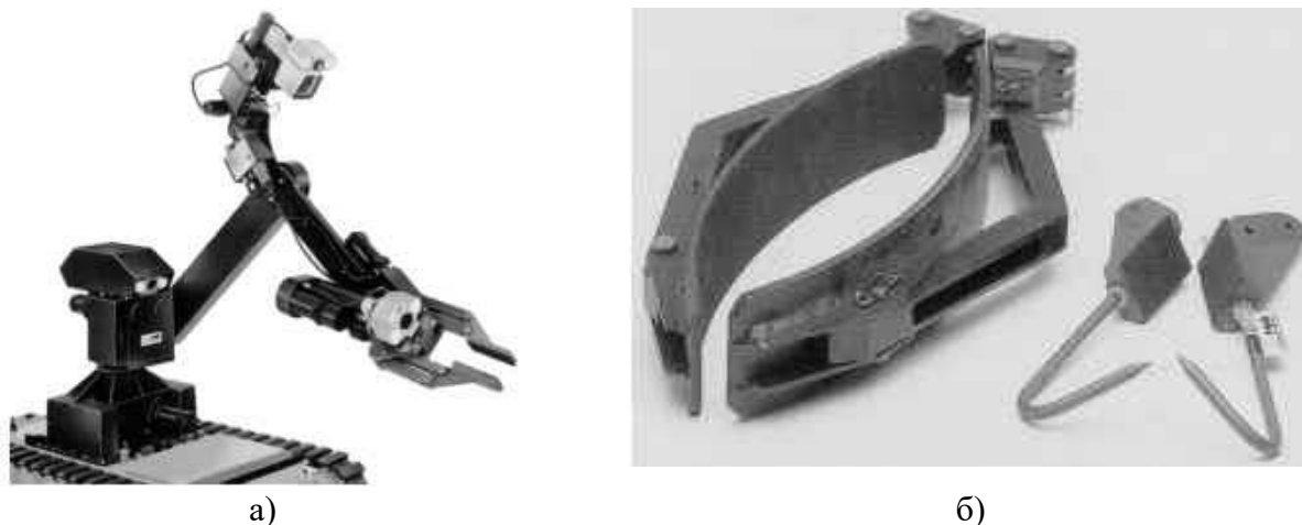
Рис. 8. Манипулятор мобильного робота MV4 (комплекс TEL 600, Германия): а общий вид; б – сменные захватные устройства (слева – для захвата цилиндрических предметов типа бомб и снарядов; справа – для предметов в мягкой оболочке)
