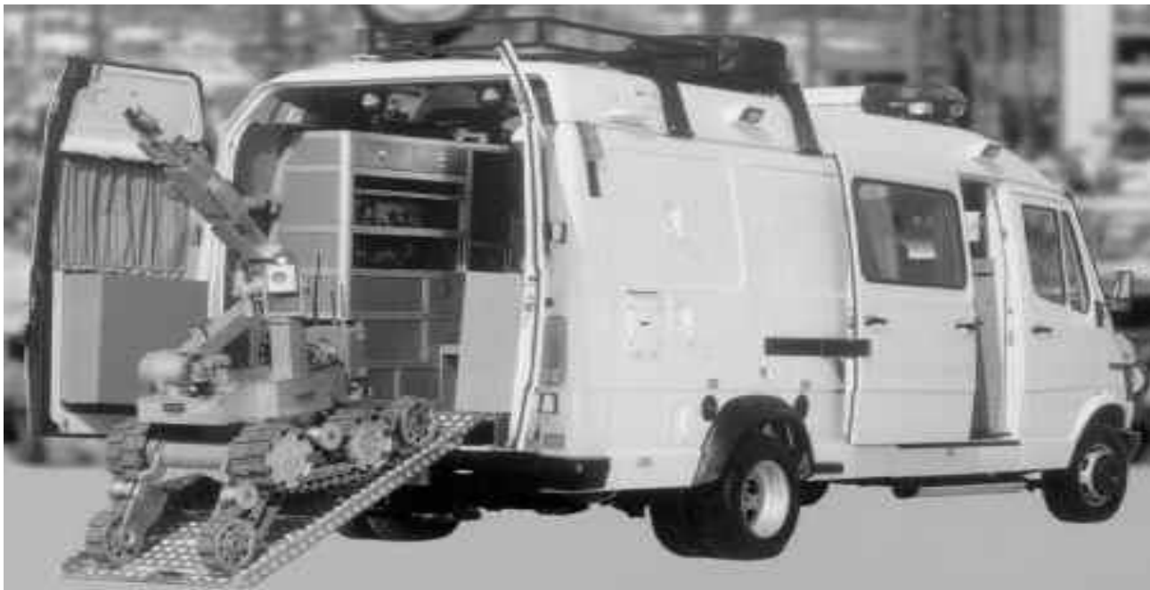
Рис. 13. Загрузка мобильного робота Andros VA по съемным аппаратам в микроавтобус комплекса MIS 2000 (Израиль)
