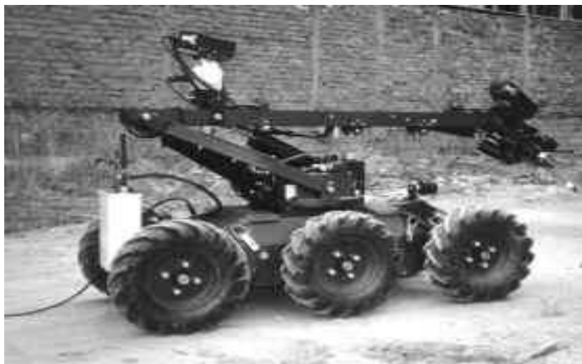
Рис. 6. Ново (Ирландия) – дистанционно управляемый мобильный 6×6 робот, входящий в состав подвижной криминалистической взрывотехнической лаборатории (Россия). Передняя и задняя оси ходовой части имеют возможности поворота относительно продольной оси машины
