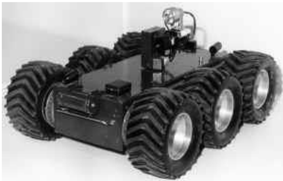
Рис. 1. Сверхлегкий мобильный робот МРК-01 (МГТУ им. Н. Э. Баумана). Предназначен для проведения инспекционных проверок, поиска и уничтожения взрывоопасных предметов. Является базовым образцом для семейства малогабаритных роботов
