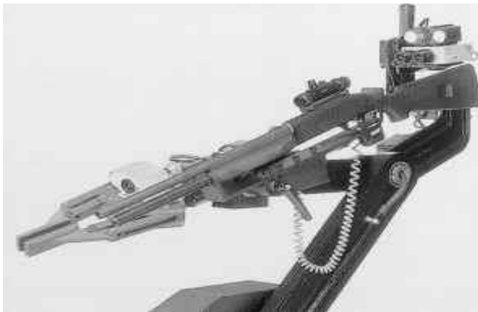
Рис. 7. Полуавтоматическое гладкоствольное ружье, установленное на манипуляторе робота MV4
