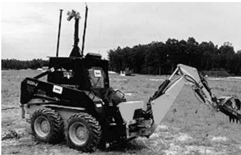
Рис. 3. Транспортное средство роботизированной системы разминирования ETODS (ОАО, США) выполнено на базе погрузчика типа Bobcat
