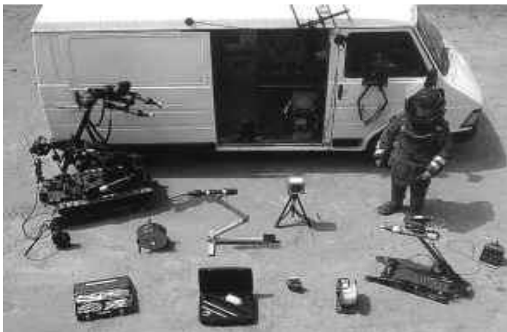
Рис. 5. Мобильный роботизированный взрывотехнический комплекс, состоящий на вооружении специальных подразделений Министерства обороны Франции.
