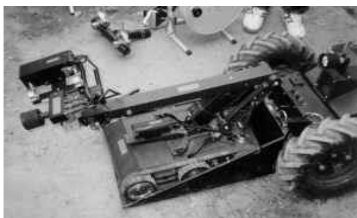
Рис. 10. Миниробот Rascal может быть доставлен к месту работы с помощью робота Нобо, также входящего в состав подвижной криминалистической взрывотехнической лаборатории
