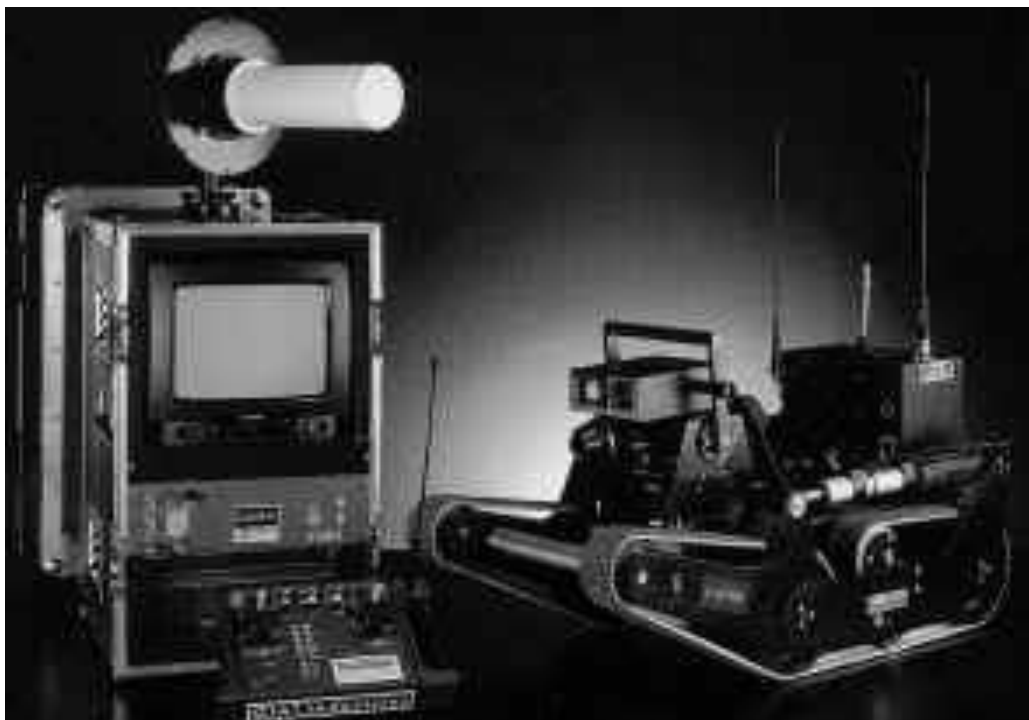
Рис. 4. Мобильный робот Castor (GIAT Industries, Франция) может иметь либо колесную, либо гусеничную ходовую часть
