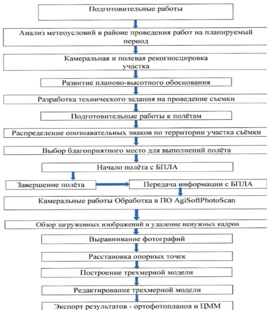
Рисунок 1 – Технологическая схема съемки с БПЛА
