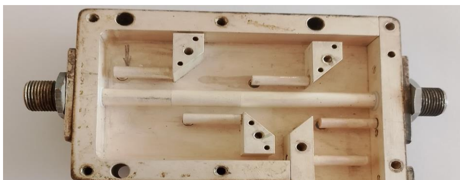
Рисунок 2. Фото режекторного фильтра
