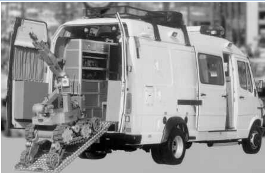
Рис. 8. Загрузка мобильного робота Andros VA по съемным аппаратам в микроавтобус комплекса MIS 2000 (Израиль)
