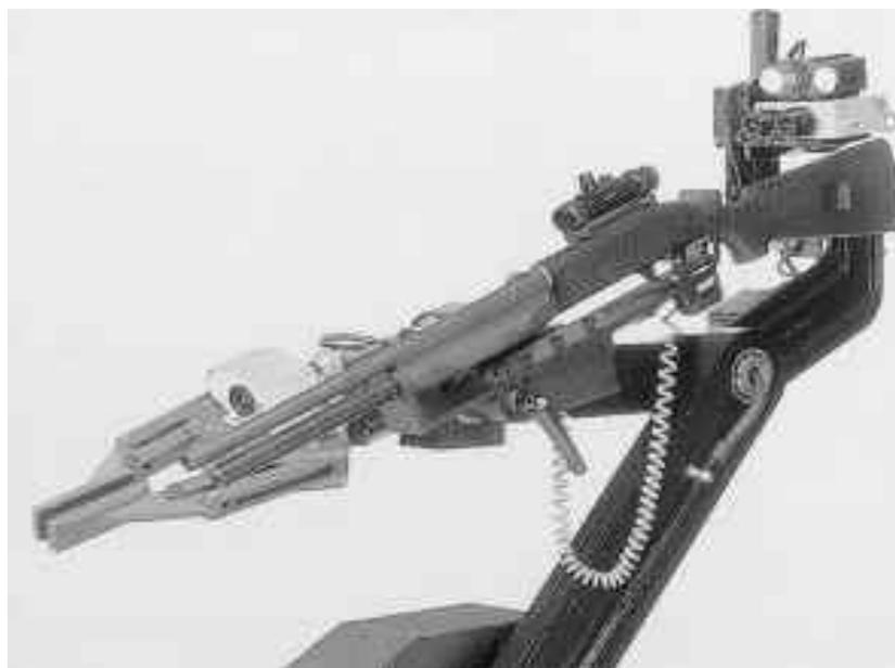
Рис. 2. Полуавтоматическое гладкоствольное ружье, установленное на манипуляторе робота MV4
