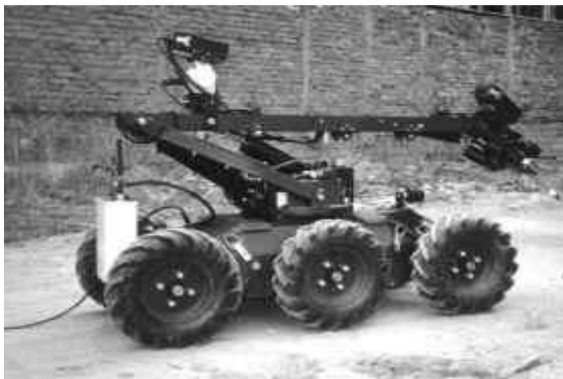
Рис. 1. Нобо (Ирландия) – дистанционно управляемый мобильный 6×6 робот, входящий в состав подвижной криминалистической взрывотехнической лаборатории (Россия). Передняя и задняя оси ходовой части имеют возможности поворота относительно продольной оси машины
