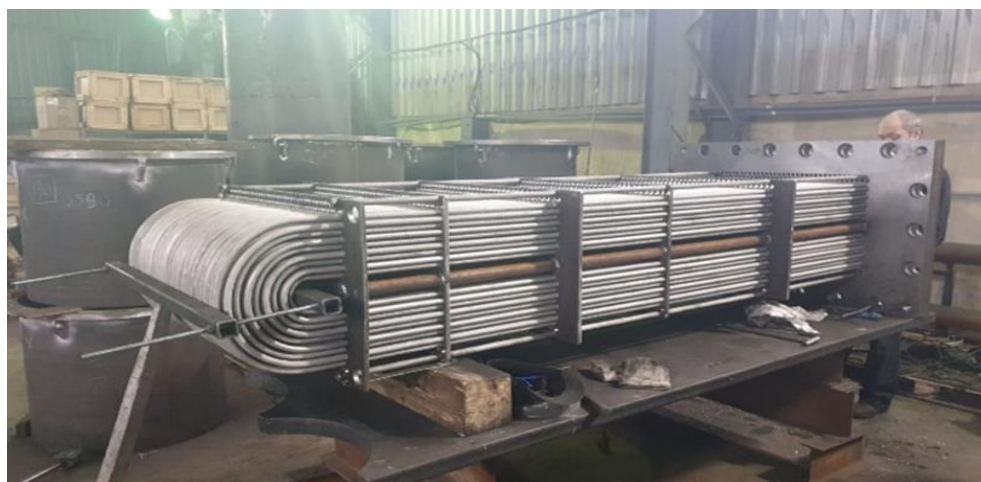
Рис. 4. Новый трубный пучок ПС-115
