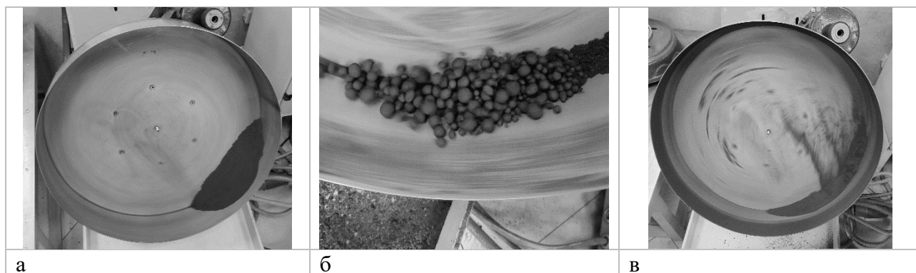
Рис.1. а) загруженная шихта; б) образовавшиеся окатыши; в) разрушившиеся окатыши.
