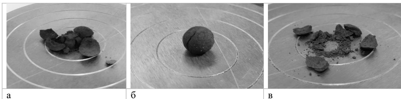
Рис. 2. Сырые окатыши после испытания на прочность: а) образец №1; б) образец №2; в) образец №3
