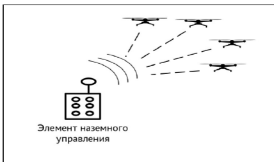
Рис. 1 Схема, централизованной архитектуры управления
