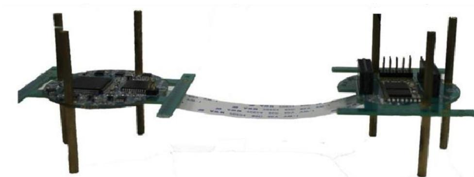
Рисунок 7 – Микрофонная решетка и модуль усиления, фильтрации, обработки и передачи акустического сигнала, соединенные шлейфом
