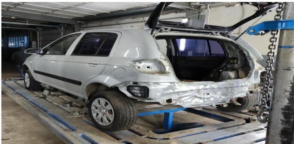
Рисунок 4. Платформенный стапель на предприятии «Element Service»
