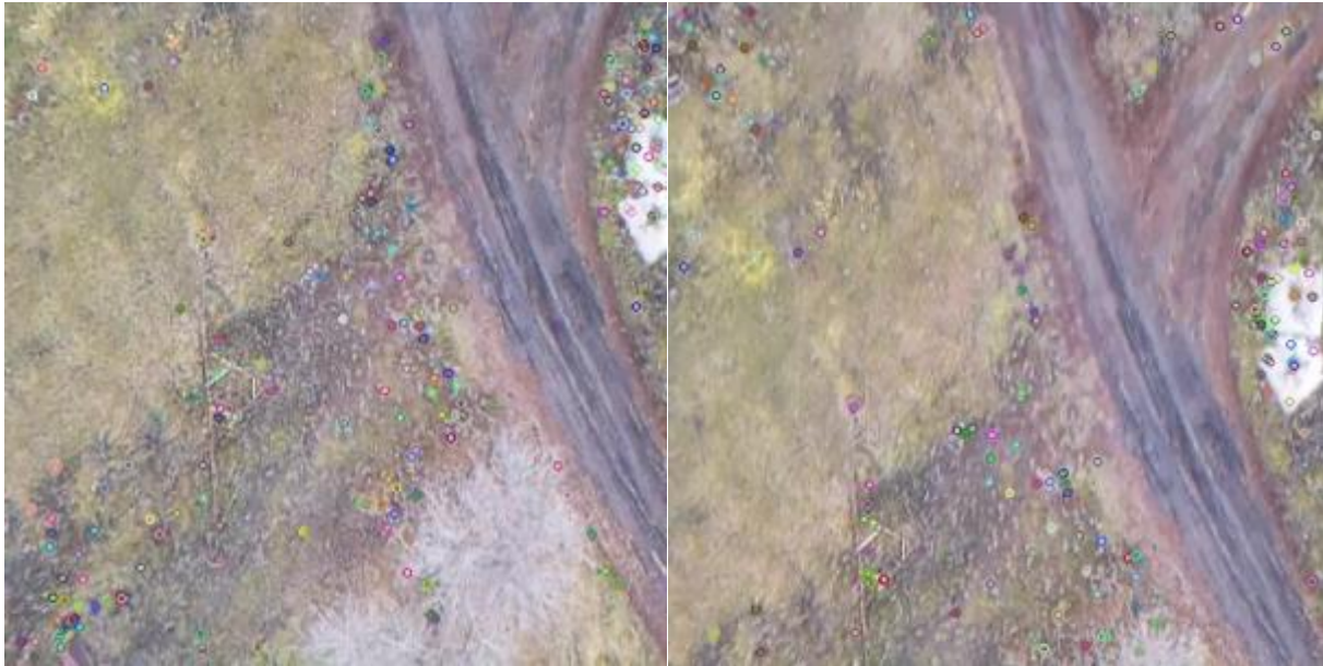
Рисунок 9. Структура обнаруженных с помощью KAZE «особых точек»
