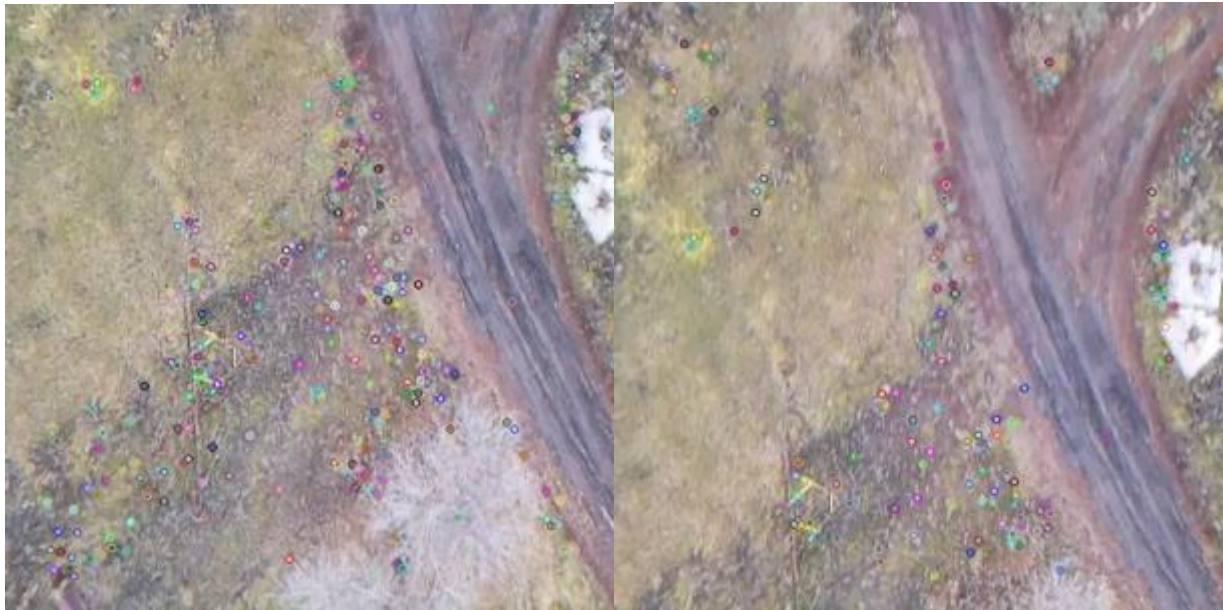
Рисунок 11. Структура обнаруженных с помощью AKAZE «особых точек»
