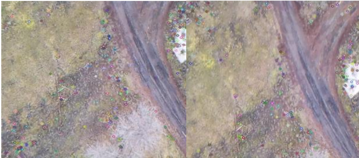
Рисунок 9. Структура обнаруженных с помощью KAZE «особых точек»
