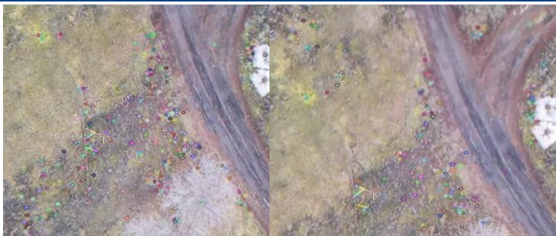
Рисунок 11. Структура обнаруженных с помощью AKAZE «особых точек»
