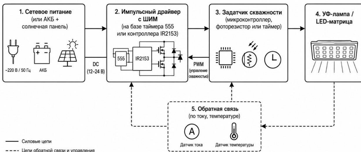
Рисунок 1. Структурная схема световодушки с оптимизированным импульсным питанием
