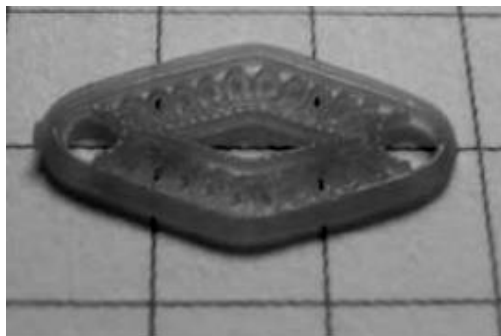
Рисунок 4 – Восковая форма «листоподобного» филигранного предмета
