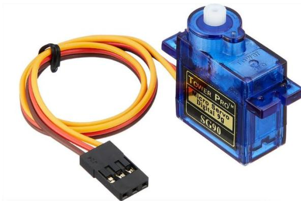
Рис 1. Сервопривод SG90
