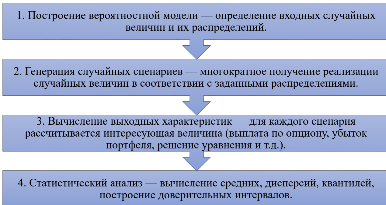
Рисунок 1. Алгоритмическая схема применения метода Монте-Карло
