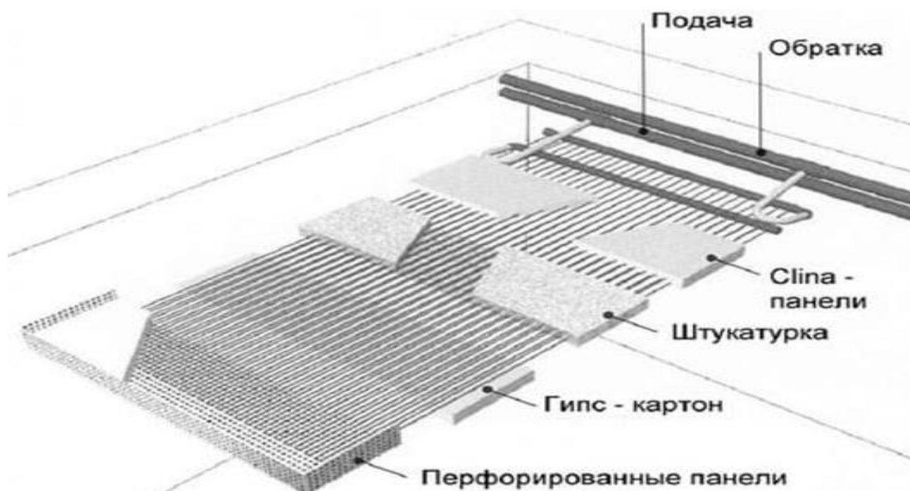
Рисунок 1 – Система холодных потолков с использованием капиллярных матов
