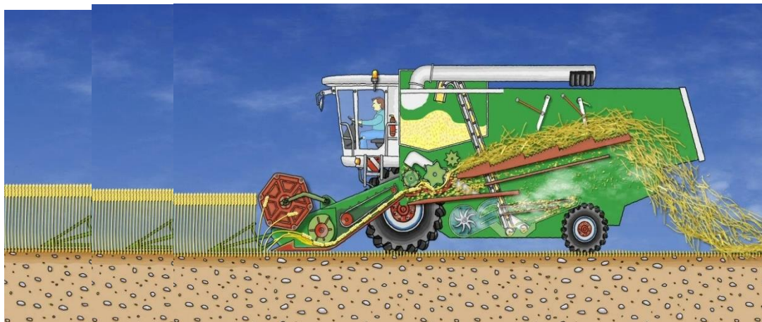
Рисунок – Схема движения зерноуборочного комбайна по полю
