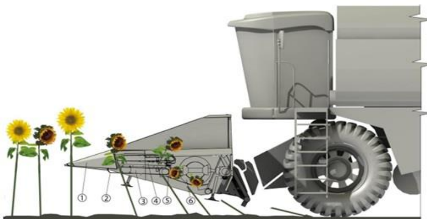
Рисунок 2. Технологическая схема работы жатки FALCON: 1-делитель лифтера; 2-лифтер; 3-транспортер семян; 4 -транспортер стеблей;5-режущий аппарат; 6-шнек
