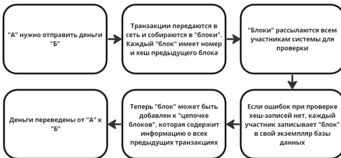
Рис. 1. Схема работы технологии блокчейн [3]
