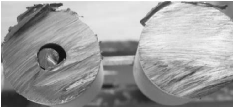
Рис. 2. Следы перепиливания засова угло-шлифовальной машиной.
