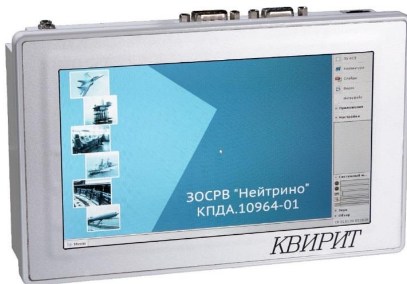
Рис.5 Пример создания абонентского устройства типа планшет на базе более раннего процессорного модуля 1892VM14Я («Элвис»), разработанного в АО «РИМР» в рамках инициативной работы «МК Конструктор»
