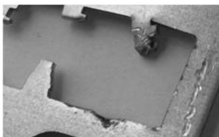
Рис. 6. Следы взлома на третьей сувальде.
