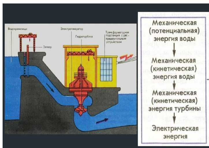
Рисунок 3 – Принцип работы ГЭС
