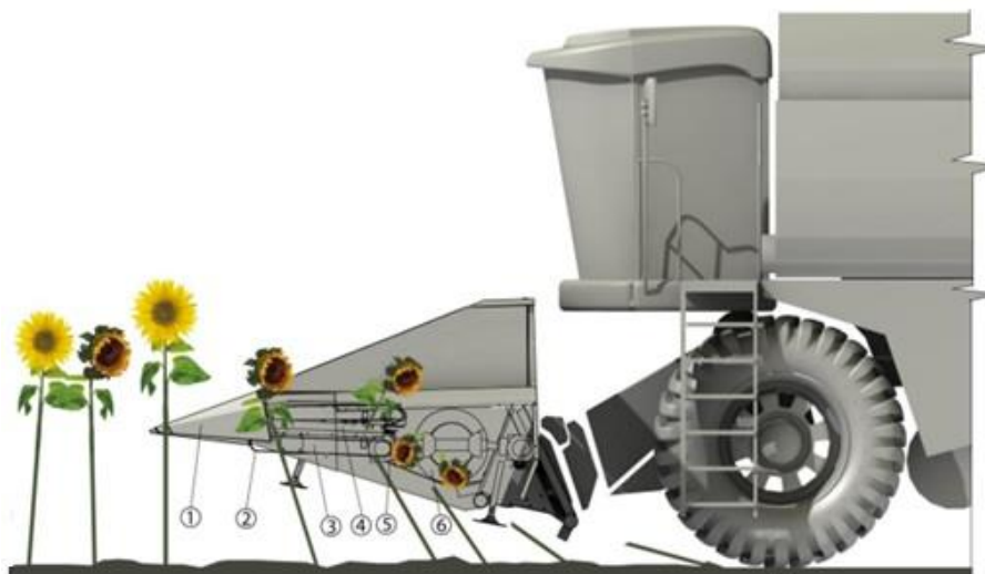
Рисунок 2. Технологическая схема работы жатки FALCON: 1-делитель лифтера; 2-лифтер; 3-транспортер семян; 4 -транспортер стеблей;5-режущий аппарат; 6-шнек
