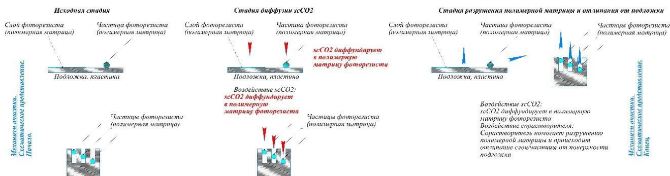
Рисунок 2 - Схема процесса удаления остатков фоторезиста [4]
