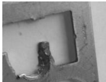
Рис. 7. Следы взлома на четвертой сувальде.
