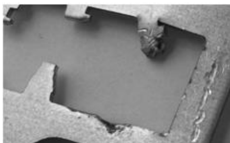
Рис. 6. Следы взлома на третьей сувальде.
