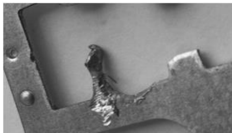
Рис. 8. Следы взлома на пятой сувальде.
