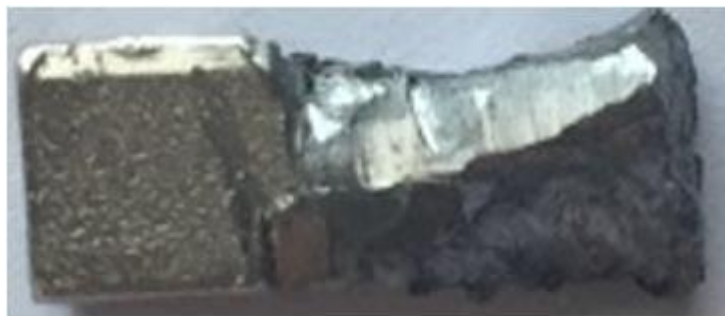
Рис. 3б. Следы взлома на засове.
