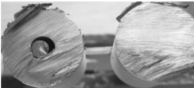
Рис. 2. Следы перепиливания засова угло-шлифовальной машиной.
