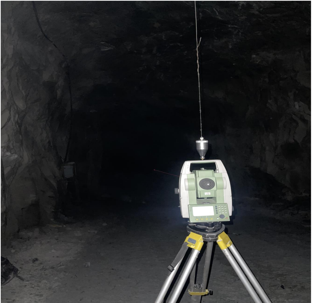
Рисунок 1.1 Маркшейдерские съемки выработок для формата 3D
