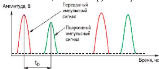
Рис. 7. – Иллюстрация принципа действия импульсного лидара (измерение TOF)
